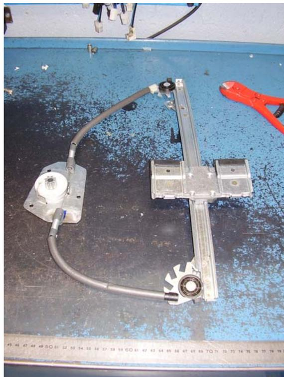
**Figura 16: Prototipo ZT SK704 L pronto per la prova in portiera**
