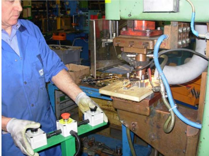
**Figura 19: saldatura di piastre motore (alzacrystallo Arm&Sector)**
