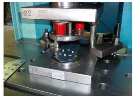
Figura 18: Stampo per la realizzazione delle borchie di saldatura
