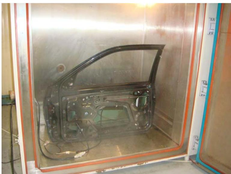
**Figura 5** Portiera Peugeot 106 nella prova in camera climatica
