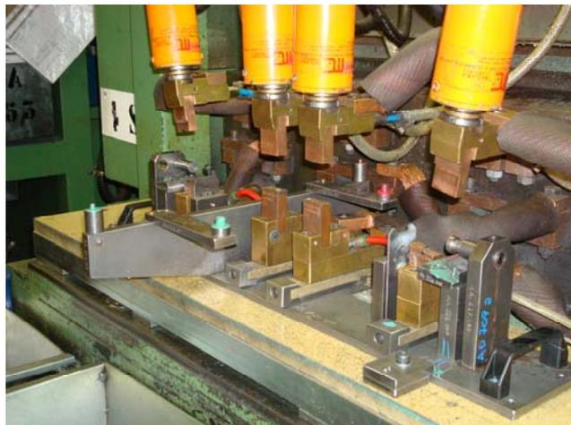
**Figura 22: Stampo di saldatura per supporti puleggia**
