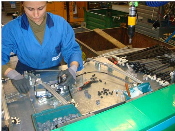
**Figura 20: assemblaggio su dima (alzacrystallo doppio Bowden)**
