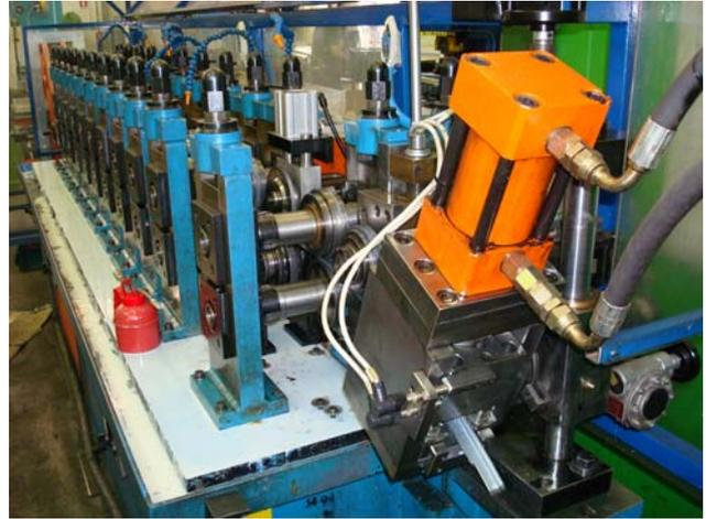
Figura 17: Profilatrice per guide Bowden
