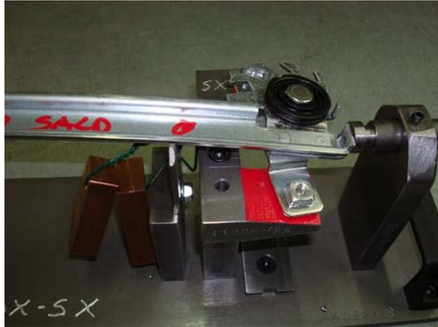
Figura 23: particolare stampo di saldatura per staffe
